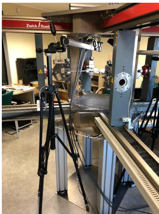
Rys. 4.1. Maszyna Biax firmy Zwick Roell
