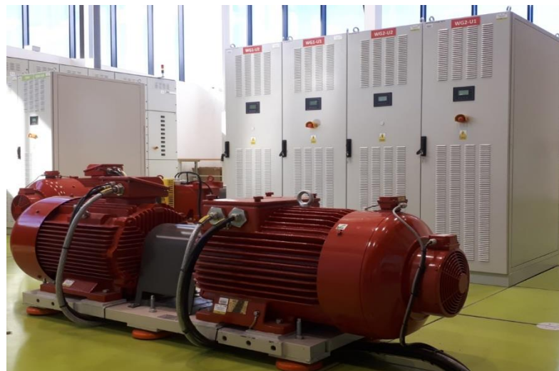
Rys. 6.1. Stanowisko skalowalnego modelu siłowni wiatrowej w Laboratorium LINTE 2 .
