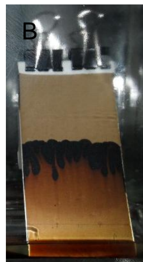
Rycina 5-1 A – Ilustracja sposobu impregnacji płytki TLC roztworem asfaltenów/ frakcji asfaltenowych; B – Fotografia przedstawiająca etap odmywania acetonem części frakcji asfaltenów/ frakcji asfaltenowej z płytki TLC SiO 2 impregnowanej asfaltenami z tzw. fluksu z roztworu o stężeniu 20 mg/ml w toluenie.
