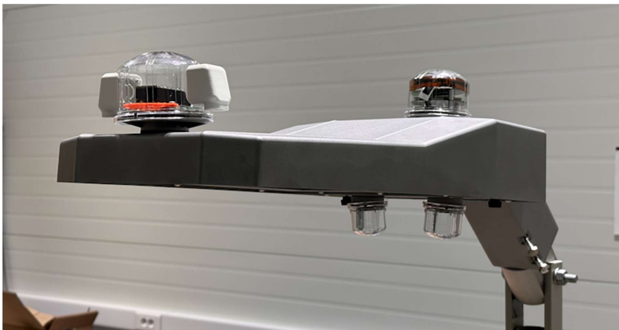
Fot. 11. Lampa inteligentna drogowa ILED z Modułem Głównym, Modułem Sensora Środowiskowego i modułami sieci WAPN typu ZigBee
