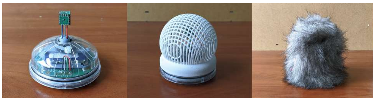
Fot. 6. Prototyp Modułu SONDY Akustycznej: bez osłony, z osłoną ochronną oraz z osłoną przeciwwiatrową
