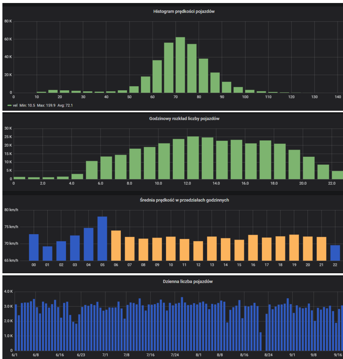
Rys. 61. Dane statystyczne uzyskane w instalacji w Leźnie na podstawie detekcji pojazdów i pomiaru ich prędkości z użyciem czujnika radarowego, wygenerowane przez system Grafana.
