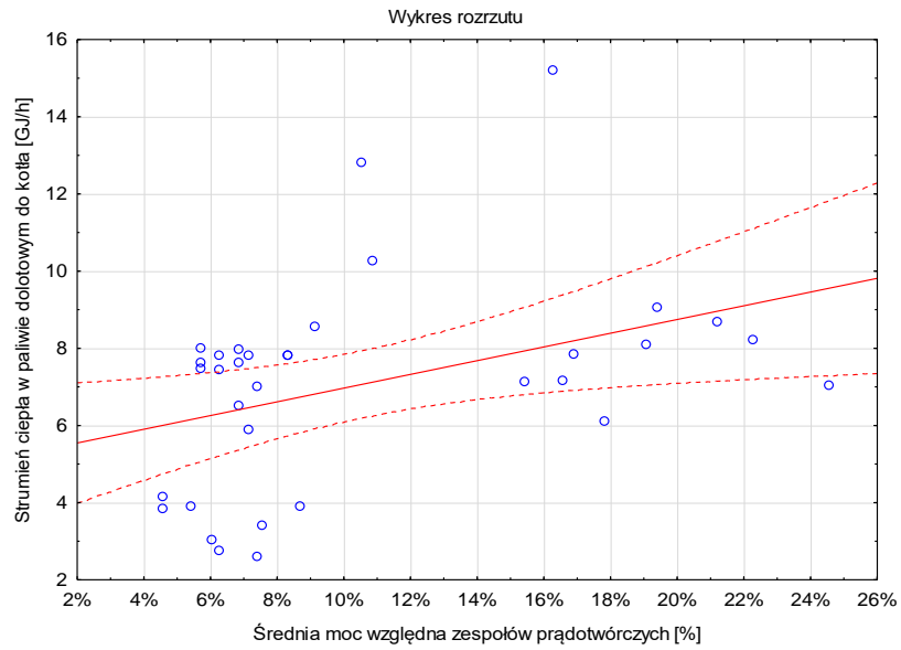
Wykres korelacji strumienia ciepła dolotowego do kotła i średniej mocy względnej zespołów prądotwórczych.
