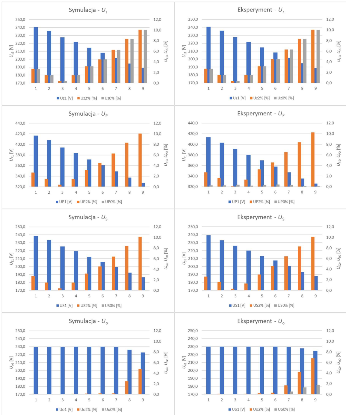
Rys. 5.56. Wyniki badań (symulacja i eksperyment) wpływu niesymetrii zasilania na stabilizację napięcia obciążenia przez układ DTH (na osi x kolejne numery prób zgodnie z tablicami 5.7 i 5.8; punkty pomiaru napięć zgodnie z rys. 5.55)
