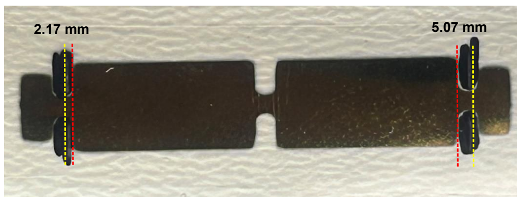
Rys. 6.3. Niesymetryczność spoin na brzegach siłownika
