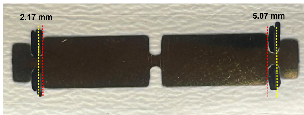
Rys. 6.3. Niesymetryczność spoin na brzegach siłownika
