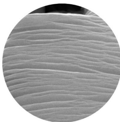
Rysunek 8. Struktura harmonijkowa MXenu otrzymywana w wyniku procesu wytrawiania związku fazy MAX - Ti_3AlC_2 [zdjęcie własne]
