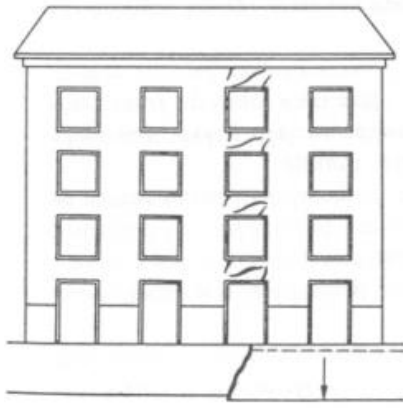
Rys. 2-33. Rysy ściany wskutek nierównomiernego osiadania [124]
