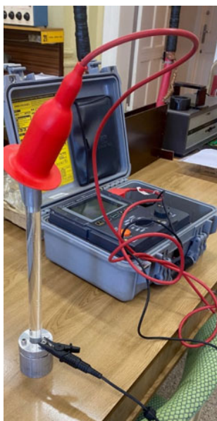
Rys.6. Wyznaczanie rezystywności słupa wody w rurce szklanej
