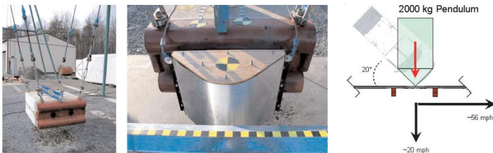
Rys. 2.22 Przykład wykorzystania wahadła do testów zderzeniowych z barierami ochronnymi.
