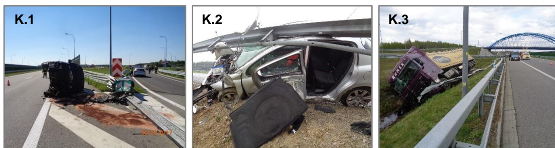
Rys. 5.9 Grupy zdarzeń K.1-K.3 wywołane najechaniem pojazdu na barierę ochronną
