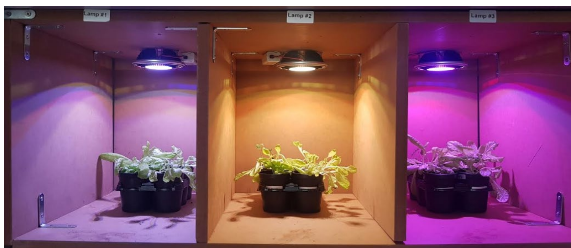
Rys. 3. Widok opracowanego przenośnego stanowiska badawczego w trakcie uprawy bazylii.
