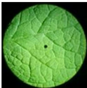
Rys. 21. Widok z wizjera przyrządu pomiarowego (czarna kropka określa pole pomiaru).
