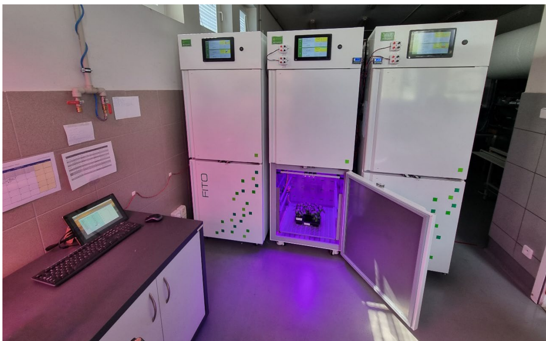
Rys. 15. Widok stanowiska badawczego opartego na szafach fitotronowych.
