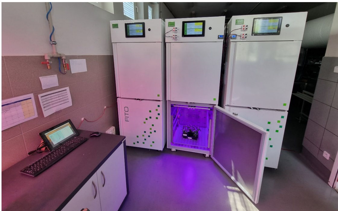
Rys. 15. Widok stanowiska badawczego opartego na szafach fitotronowych.
