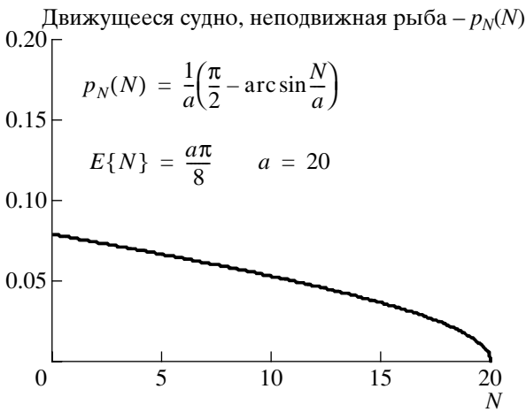
Рис. 2. Теоретическая функция плотности вероятности (ФПВ) числа N эхо-сигналов в рыбных следах для модели с движущимся судном и неподвижной рыбой.
