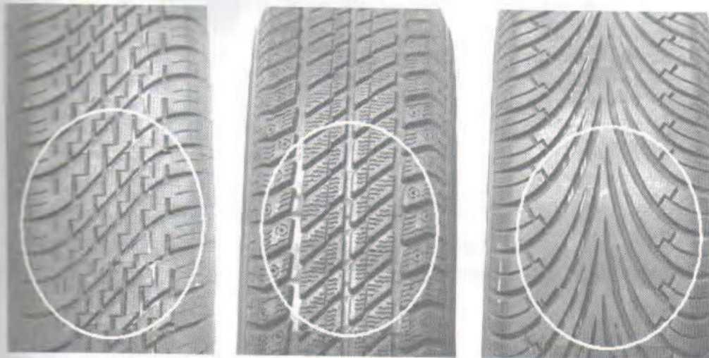
Rys. 4. Komercyjne wzory bieżników, w których przebieg rowków nie pokrywa się z krawędzią śladu styku opony z jezdnią.
