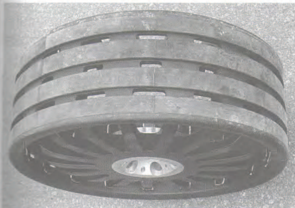
Rys. 13. Kompozytowe „Koło Hanssona” z wentylowanym bieżnikiem. Fig. 13. Composit tyre “Hanssen’s Wheel” with ventilated tread
