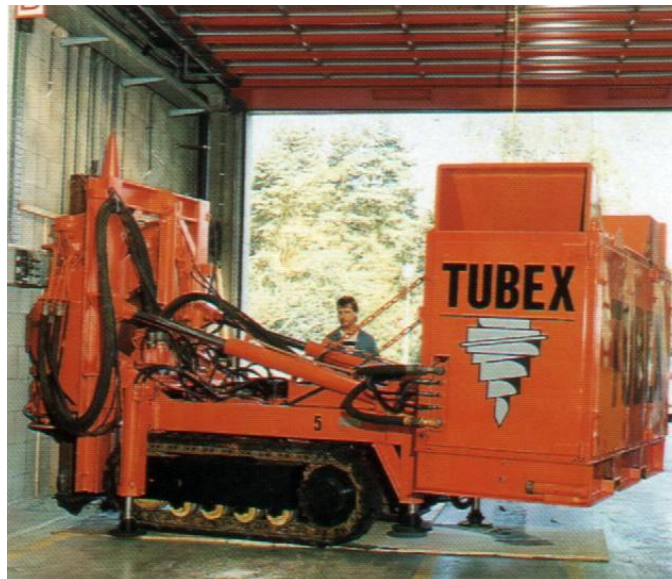
Rys. 5. Maszyna do wykonywania pali Tubex
